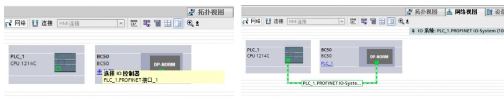
Fig 72. PLC Profinet-通过 Profinet 接口连接 PLC 与 BC50 读码器
